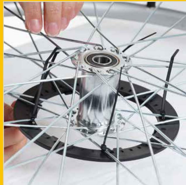
**03** Unteren Teil zentriert auf die Speichen legen, 6 Kabelbinder gleichmäßig verteilt von hinten einfädeln und festziehen
