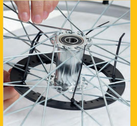
**03** Unteren Teil zentriert auf die Speichen legen, 6 Kabelbinder gleichmäßig verteilt von hinten einfädeln und festziehen
