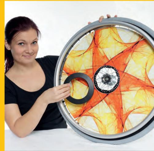
**05** Speichenschutz einlegen und mit Schnellwechselsystem einfach und schnell wechseln oder reinigen.
